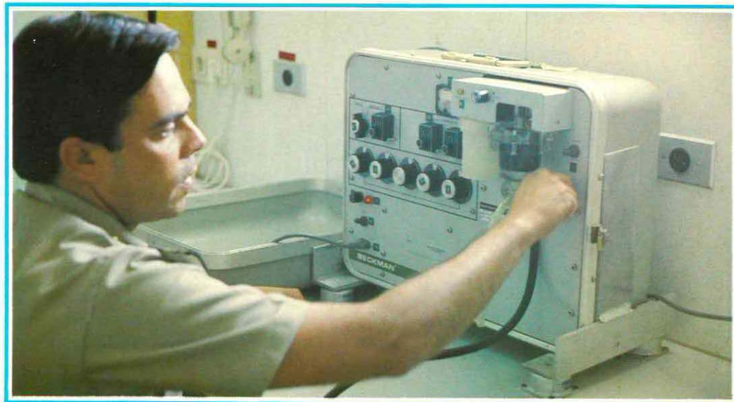
La Operación de una moderna tecnología (en la gráfica un termosalinómetro de inducción) ofrecen a las investigaciones realizadas por el CIOH un alto índice de precisión.
