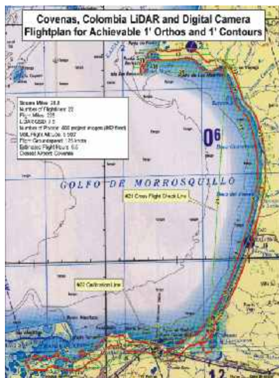
Figura 7. Líneas de vuelo (en color verde) y límite aproximado de la zona de trabajo (línea roja) en el Golfo de Morrosquillo.
