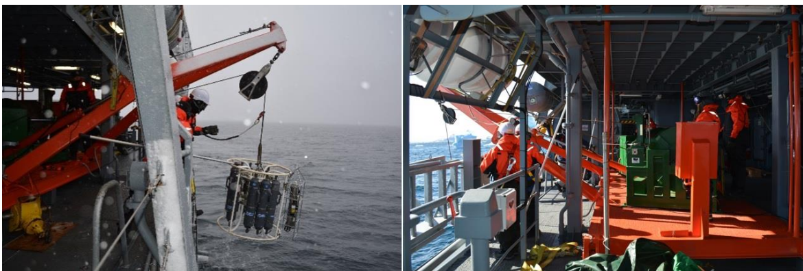
Fotografía 30. Maniobra de lanzamiento de Roseta muestreadora con 10 botellas y CTD, empleando la PMO. Izq. equipo a la pendura antes de iniciar arriado; der. La PMO con el marco A y extensión a su máxima capacidad.
