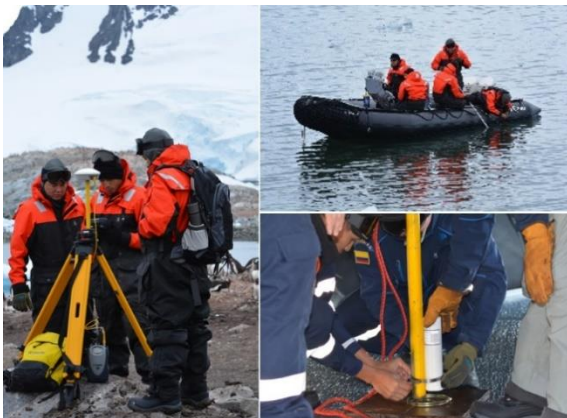
Fotografía 24. Instalación y nivelación de sensor de nivel del mar.
