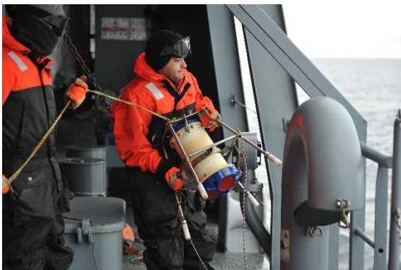
Fotografía 26. Colocación del ADCP por el costado de estribor.
