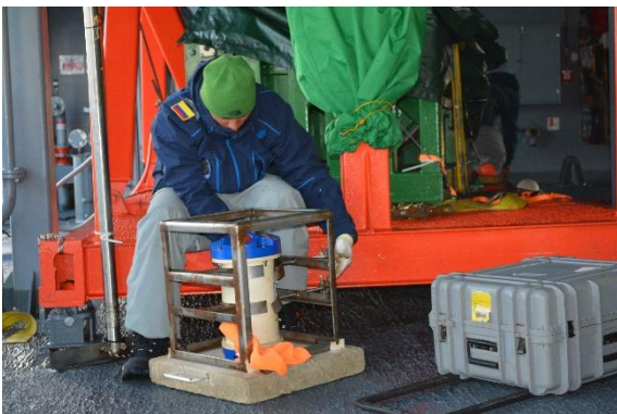
Fotografía 25. Preparación del equipo ADCP.
