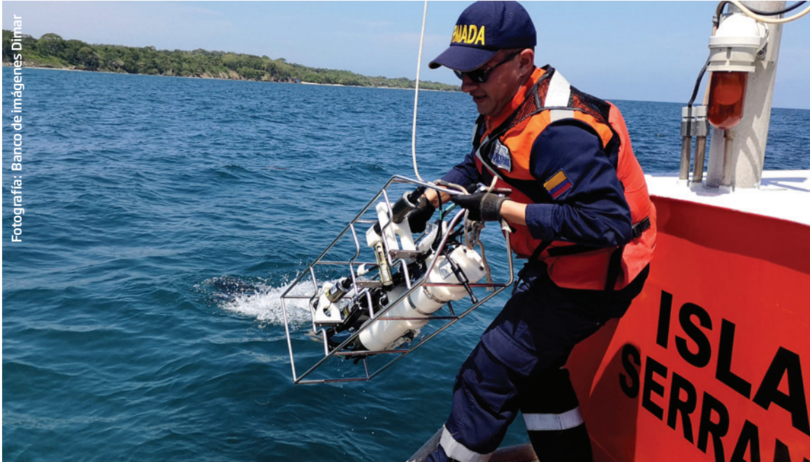
Toma de datos de perfil de la columna de agua empleando el equipo CTD.
