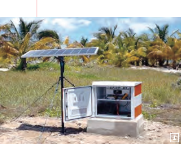
Figura 1. Estación CAYS puesta en operación en el año 2012. (Antena geodésica, izq) y (gabinete para almacenamiento del receptor con sistema fotovoltaico, der).
