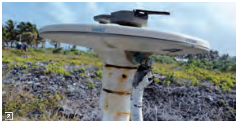
Figura 1. Estación CAYS puesta en operación en el año 2012. (Antena geodésica, izq) y (gabinete para almacenamiento del receptor con sistema fotovoltaico, der).
