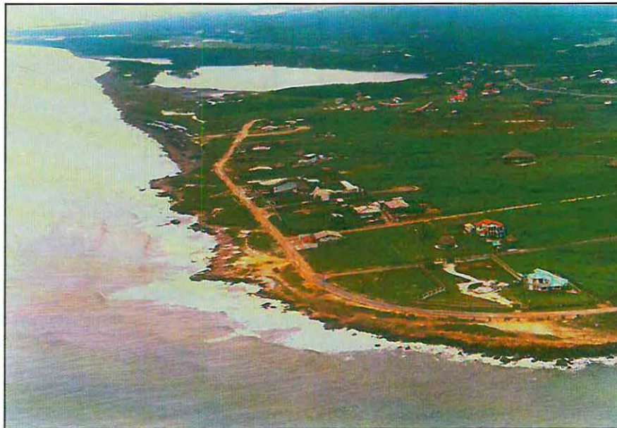
Figura 7. Vista panorámica en dirección al norte que muestra la incidencia frontal del oleaje sobre las costas de la plataforma de abrasión en Punta Sabanilla y Ciénaga de Manatíes, situación que acelera los procesos de erosión.
