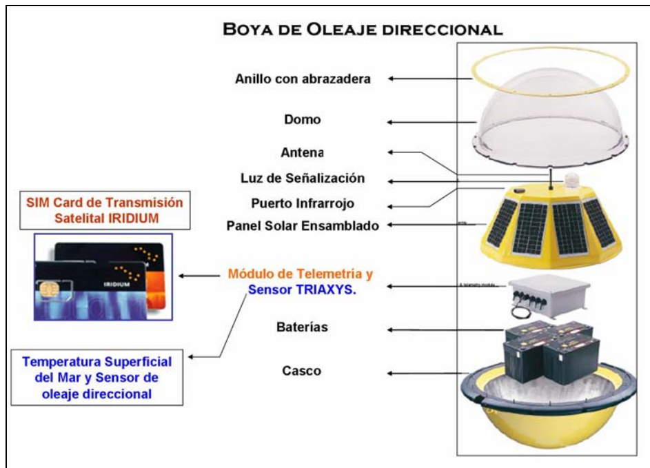
Figura 23: Esquema Boya de Oleaje Direccional Triaxys. Fuente: Dirección General Marítima - DIMAR
