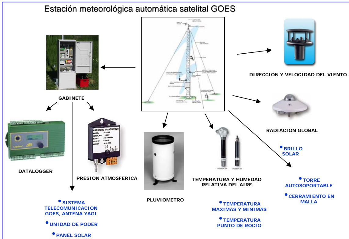
Figura 12. Sensores y elementos que componen la estación meteorológica automática con transmisión satelital GOES. Fuente: Este trabajo de tesis
