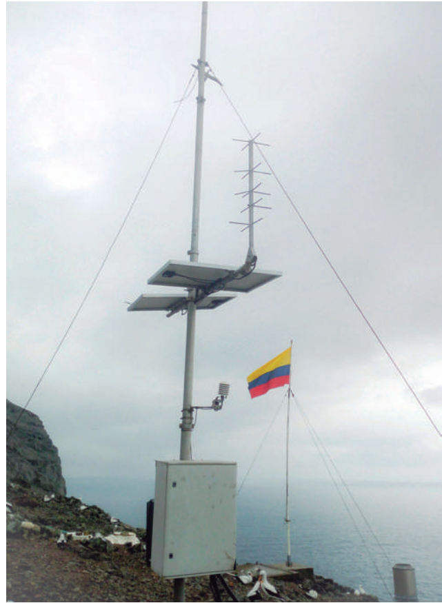
Figura 2. Estación meteorológica automática y mareográfica (EMMA) instalada en Santuario de Fauna y Flora Isla Malpelo.
