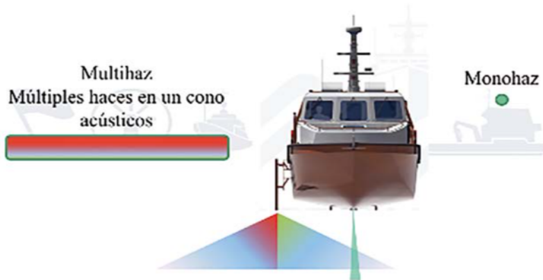
Figura 1. Comparación de un sistema monohaz y uno multihaz. Mientras la huella en el piso de un equipo monohaz es un punto, la sonda multihaz recoge una "cinta" de múltiples ecos (Com. personal, R. Guzmán, 2020).
