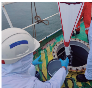
Figura 2. Toma de muestra biológica en buque utilizando red cónica simple.
