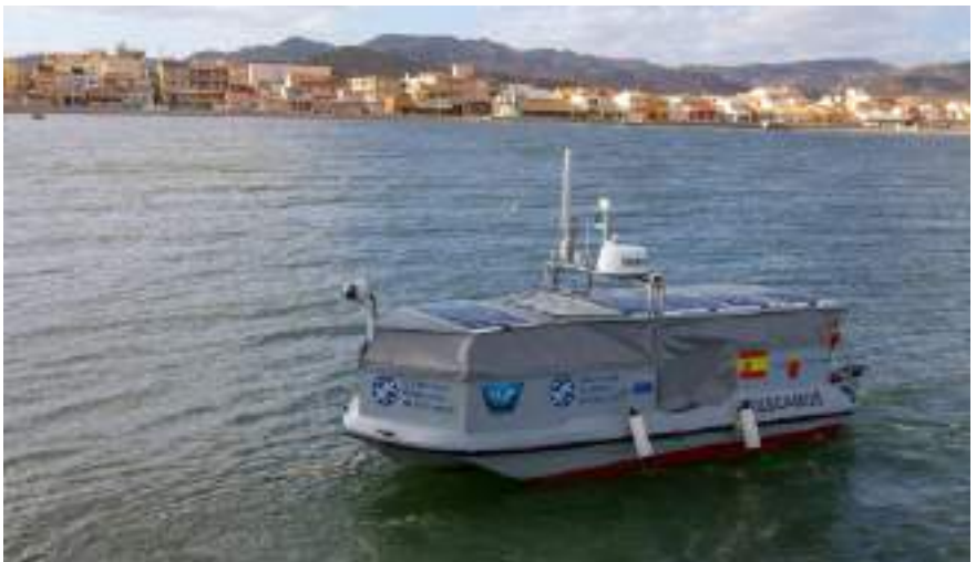
Figura 2. Vehículo de Superficie No Tripulado (USV) desarrollado por la Universidad Politécnica de Cartagena (UPCT) de España, para el control y la vigilancia de las reservas marinas protegidas y las áreas acuícolas https://www.upct.es/destacados/cdestacados.php?c=11&ubicacion=general&id_buscar=10333
