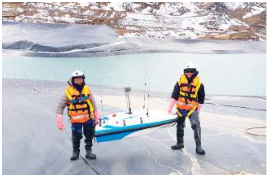
Figura 7: Vehículo de Superficie No Tripulado (USV) empleado por la empresa T&S Servicios de Ingeniería, utilizado en la presa de relaves de la Unidad Minera Inmaculada, ubicada en Ayacucho. https://www.grupots.com/servicios/batimetria-con-riesgo-cero/21
