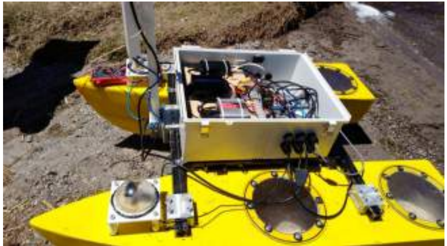
Figura 1. Vehículo de Superficie No Tripulado (USV) desarrollado por la Universidad Católica del Perú en conjunto con la University College London, y el impulso del CONCYTEC 3 , para el monitoreo de aguas continentales. http://www.cienciaactiva.gob.pe/fondecyt-informa/uso-de-tecnología-robotica-aplicada-al-monitoreo-y-control-de-la-calidad-de-aguas-continentales
