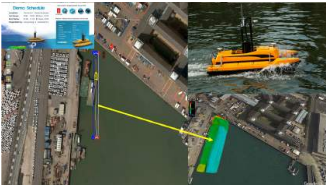
Figura 8: Vehículo de Superficie No Tripulado (USV) modelo ME 120 equipado con ecosonda multihaz, efectuando levantamiento batimétrico durante el Ocean Business 2019. https://www.oceanalpha.com/news_list/oceanalpha-and-kongsberg-to-demo-me120-usv-and-m3-snoar/
