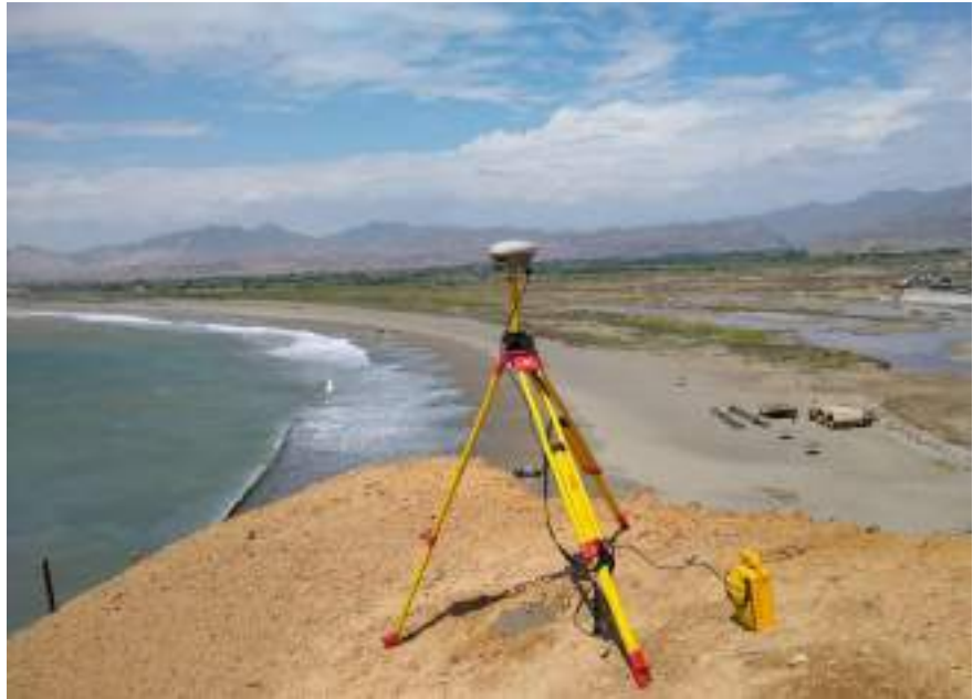
Posicionamiento con el DGPS Trimble R10 GNSS
