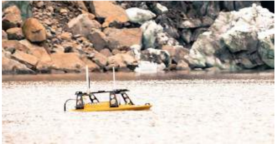
Figura 6: Vehículo de Superficie No Tripulado (USV), modelo Z-boat 1800 RP, utilizado durante los trabajos de campo en el Fiordo Taan, Alaska. http://www.teledynmarine.com/z-boat-1800rp
