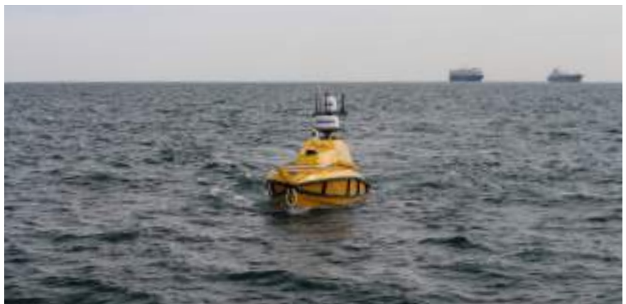
Figura 3. Modelo de Vehículo de Superficie No Tripulado (USV), tipo WORKER C-4, desarrollado por una empresa privada. https://www.asvglobal.com/product/c-worker-4/
