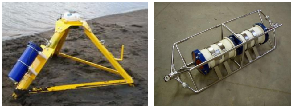
Figura 4. Montaje tipo trípode (izq.) para fondeo y para mediciones desde superficie o a media agua (der.).
