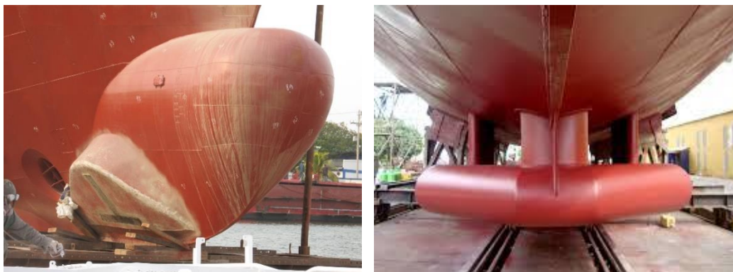
Figura 5. Góndola para diferentes equipos acústicos instalados en el casco del buque ARC “Providencia” en 2014, entre ellos un ADCP (izq.) y domo para ecosonda multihaz (der.).
