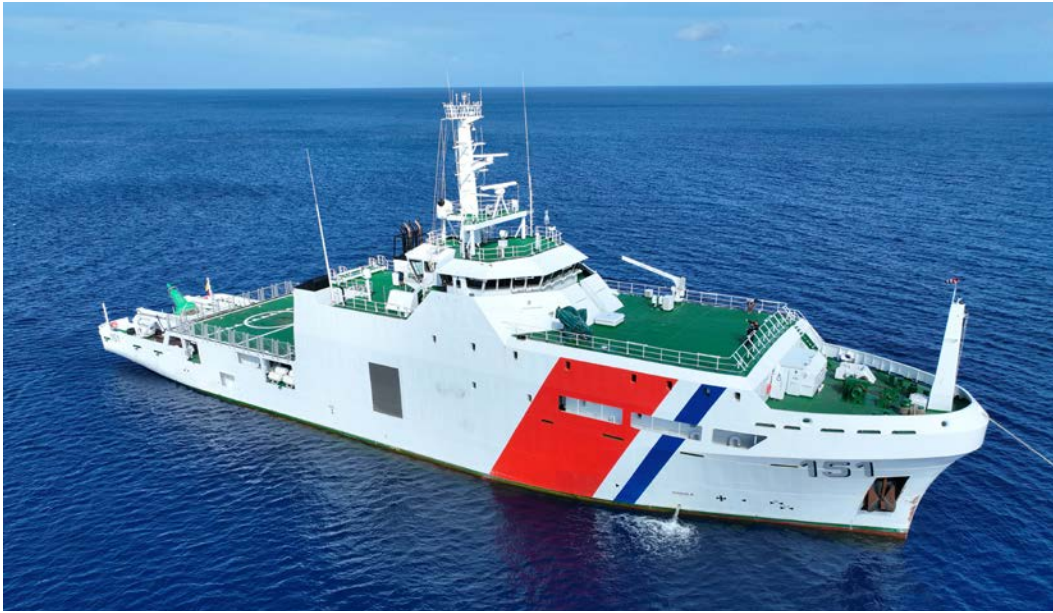
El ARC “Simón Bolívar” tiene una eslora de 83 metros, una manga de 16 metros y un desplazamiento de 3250 toneladas.
