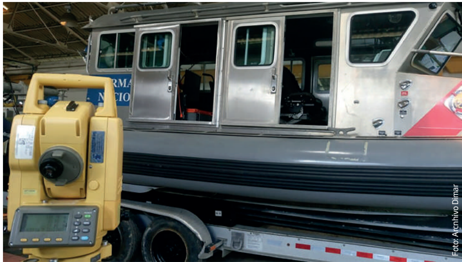
Figura 1. Determinación de offset de los sensores de la ecosonda multihaz.
