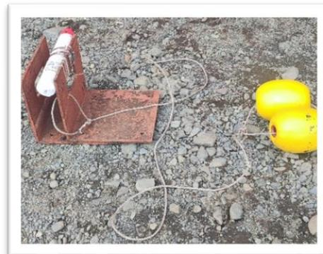
**Figura 9.** Sensor de nivel del mar RBR, instalado en punta Orión, sector de la Base Pedro Vicente Maldonado – Antártica.
