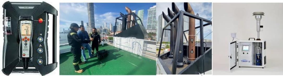
Figura 12. Recolección de información desde la salida de gases maquinaria principal del buque ARC “Simón Bolívar”.
