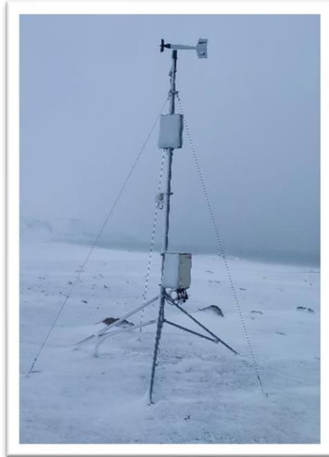
Figura 8. Estación meteorológica de fácil despliegue para condiciones antárticas.
