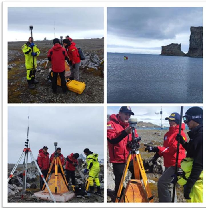
**Figura 10.** Levantamiento topométrico de RBR, utilizando un GPS Trimble R10.
