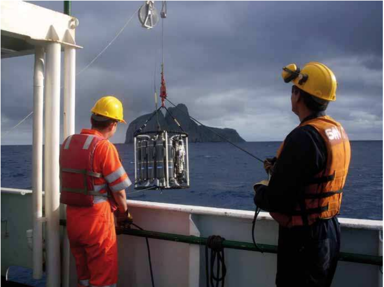
Maniobra con roseta muestreadora a bordo del buque ARC “Malpelo”, crucero oceanográfico Pacífico XLVII-ERFEN XLIVI.
