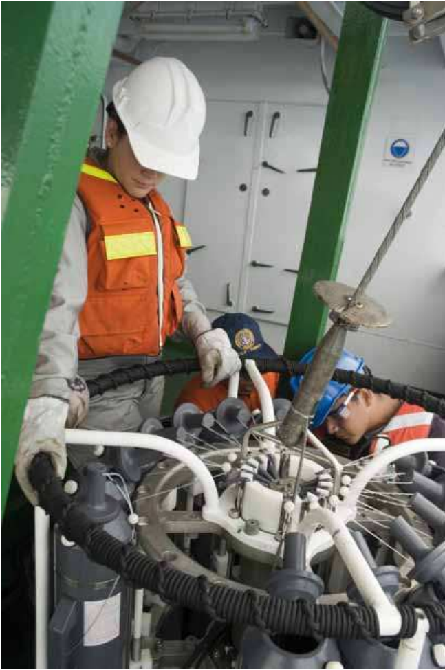
Figura 2.2. Maniobra para la recolección de muestras de agua en el océano Pacífico colombiano, por medio de la roseta muestreadora, a bordo del buque oceanográfico ARC “Providencia”.
