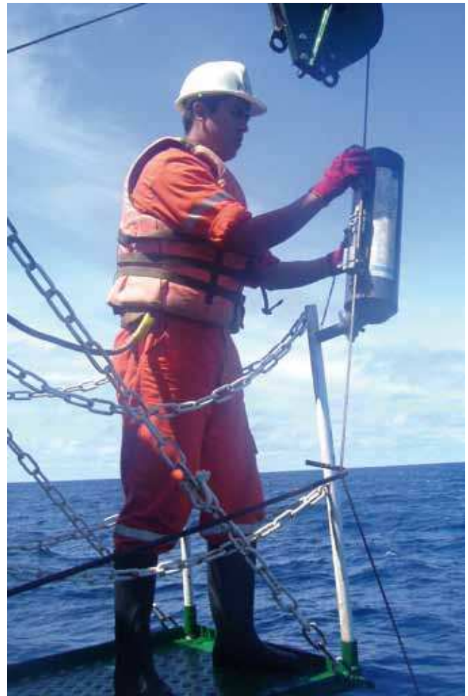
Figura 4.12. Asistente de estación oceanográfica sujetando los equipos oceanográficos a la guaya con el propósito de asegurar su arriada e izada. Crucero oceanográfico Pacífico XXXIX-ERFEN XXXVII (Sep. de 2004).
