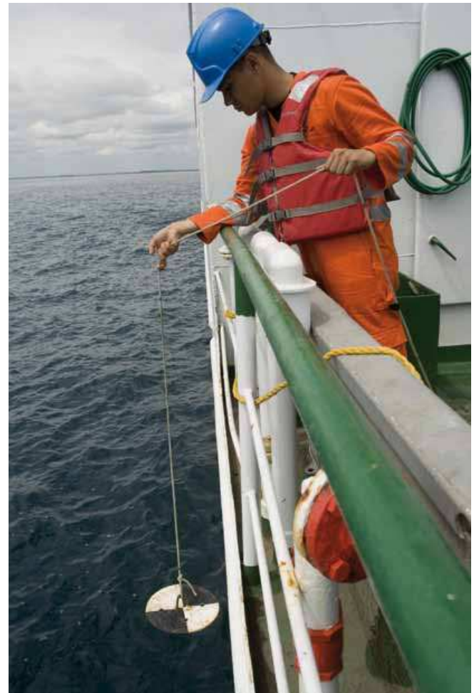
Figura 2.4. Observaciones con disco Secchi.
