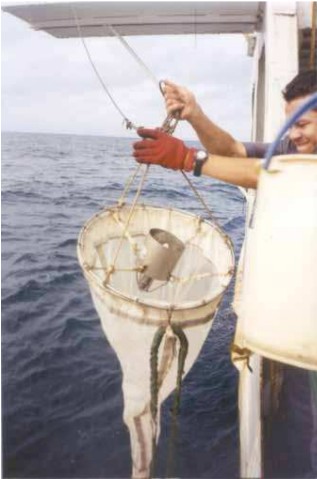
Figura 4.11. Lanzamiento de redes bongo durante el crucero oceanográfico regional Pacífico XXVI-ERFEN XXIV (Jun. de 1996).
