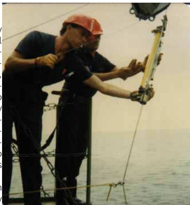
Figura 4.1. Alistamiento de una botella Nansen para muestreo de agua.
