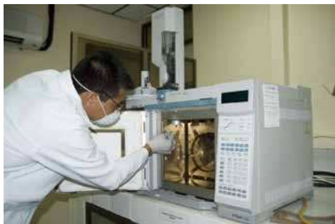
Figura 2.1. Cromatógrafo de gases acoplado a detector selectivo de masas, instrumento de medición para la adquisición de datos sobre contaminación marina.
