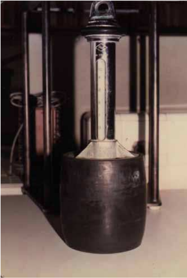
Figura 4.5. Antiguo termómetro de cazoleta con el cual se obtenía la temperatura superficial del mar (TSM).
