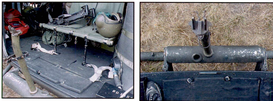
Figura 2. Análisis fotográfico de la plataforma aérea disponible para el proyecto, helicóptero Huey. Brazo de soporte del sistema de captura de información.
