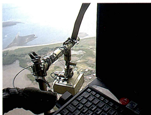
Figura 7. Sistema de captura instalado y controlado desde la plataforma aérea.
