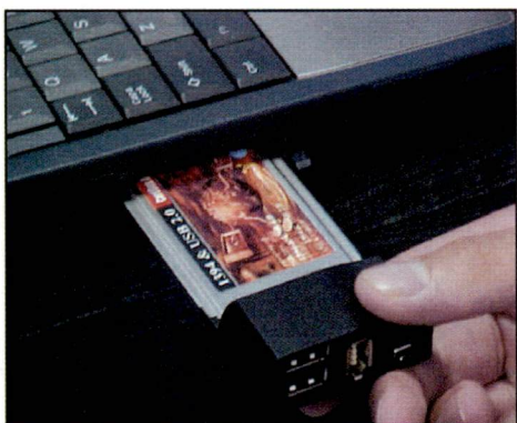
Figura 6. Instalación de la tarjeta IEE1394 en el PC portátil, para aumentar la capacidad de almacenamiento y control de las fotografías aéreas.
