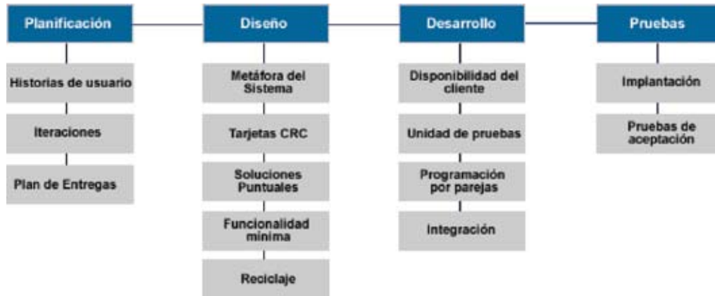
Figura 1. Fases de un proyecto usando la metodología Programación Extrema, XP.
