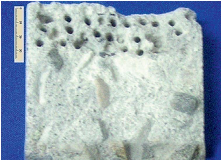
Figura 2. Perforaciones hechas en la probeta seccionada en intervalos hasta 50 mm.
